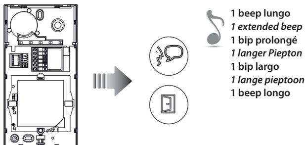
Se la memorizzazione non va a buon fine, si accendono contemporaneamente i LED Serratura e Connessione e il dispositivo emette un beep lungo.
