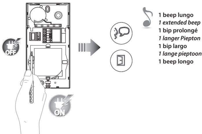
Togliere il BUS; tenendo premuto il pulsante di programmazione, ridare alimentazione. Mantenere premuto il pulsante di programmazione fino all'accensione alternata dei LED Serratura e Connessione + beep lungo.
