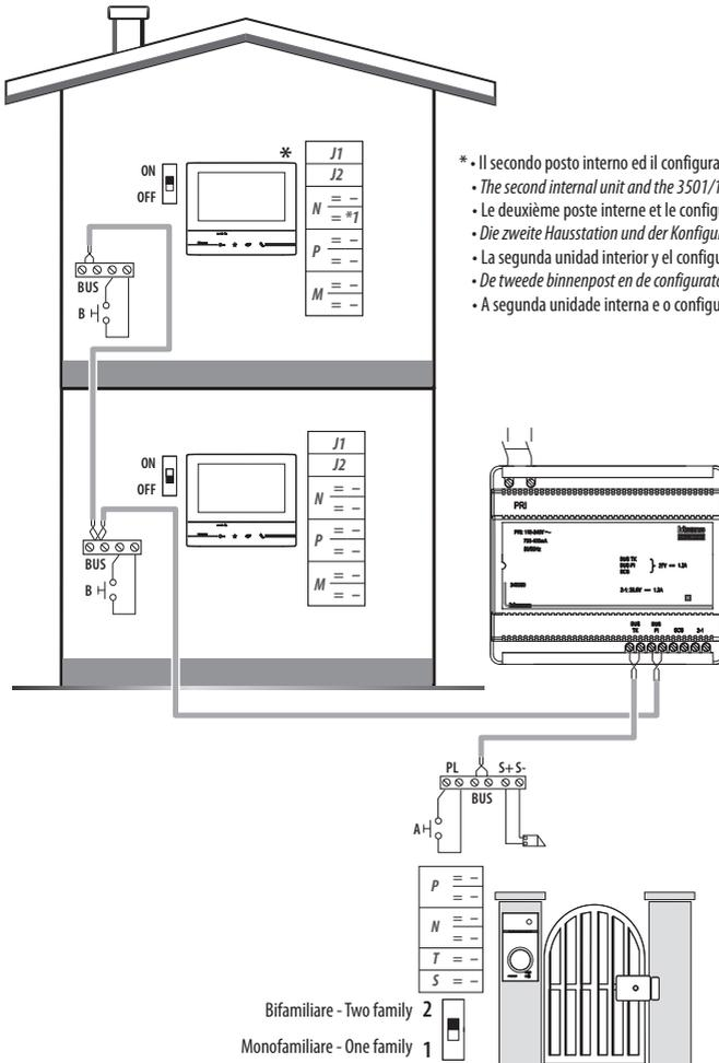
\* • Il secondo posto interno ed il configuratore 3501/1 devono essere acquistati separatamente.
